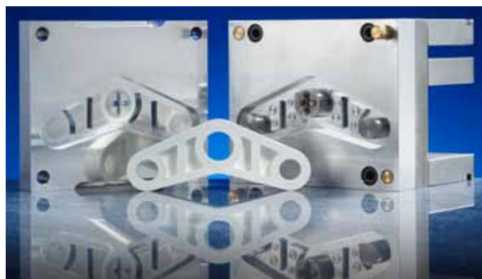
Schwenkhebel mit zugehöriger Form
